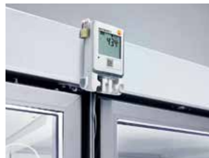
实验室超低温冷冻柜监控 外置温度，需外接温度探头(TC) (testo Saveris 2-T3)
